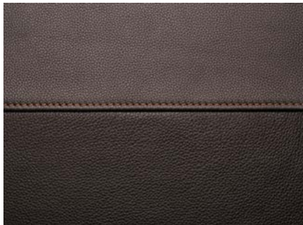
Einfache Kappnaht Simple french seam
