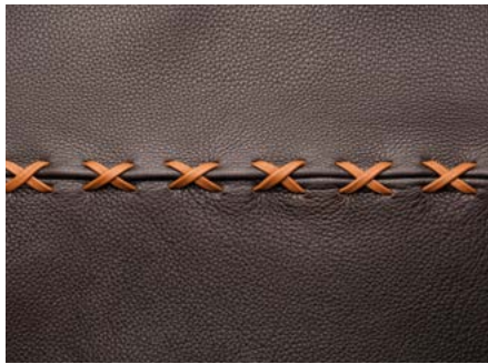
Gekreuzte Lederschnürung mit Lederriemchen Crossed leather lacing with leather stripes
